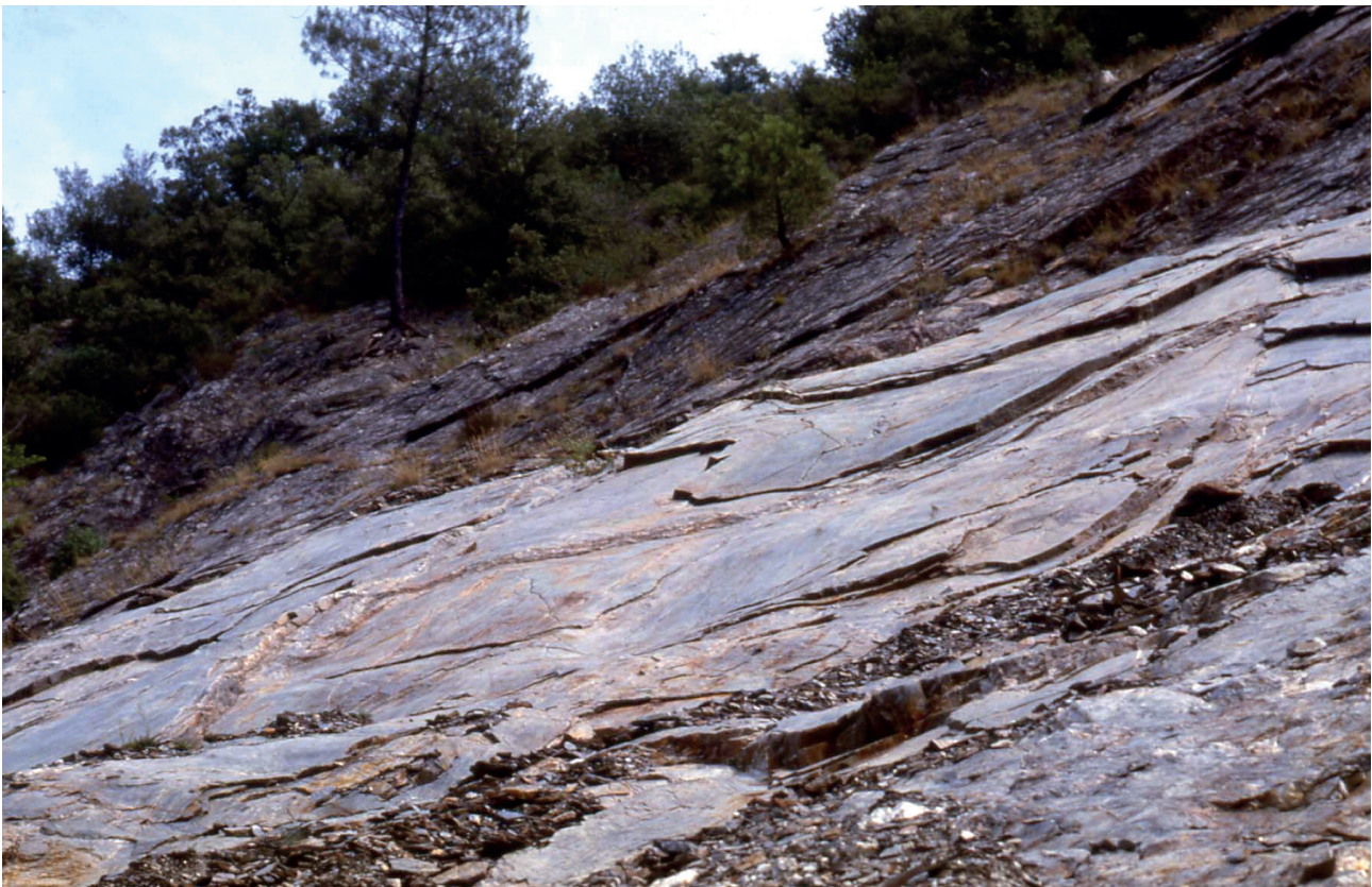
Figure 25 : Surfaces de schistosité et débit en feuillets ou plaques, avec rupture de ponts rocheux localisés, dans des schistes des Cévennes (Photographie R. Cojean)
