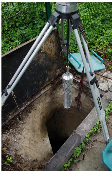
Figure 2 : Inspection par caméra pour juger de l'accessibilité d'un ouvrage (source : INERIS)
