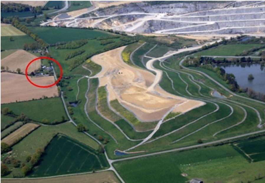
*Figure 6 : Exemple de construction de verse à stériles et présence de riverains à proximité (hameaux à gauche de la photo). La zone en exploitation au sommet présente une surface limitée en un instant « t »*
