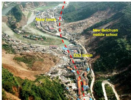
Figure 3 : Ville de Beichuan, après le séisme. Noter l'important glissement au premier plan et le bourrelet de débris d'habitations et l'éboulement au second plan. Le passage de la faille de Yingsu-Beichuan est indiqué (document transmis par Huang R.Q.)
