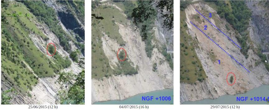
Figure 12 : Différents stades d'évolution du glissement de terrain fin juin 2015 à gauche, début juillet 2015 au centre et fin juillet 2015 à droite (avec compartiments numérotés, arbre repère sur le glissement et cote NGF du niveau d'eau de la retenue)
