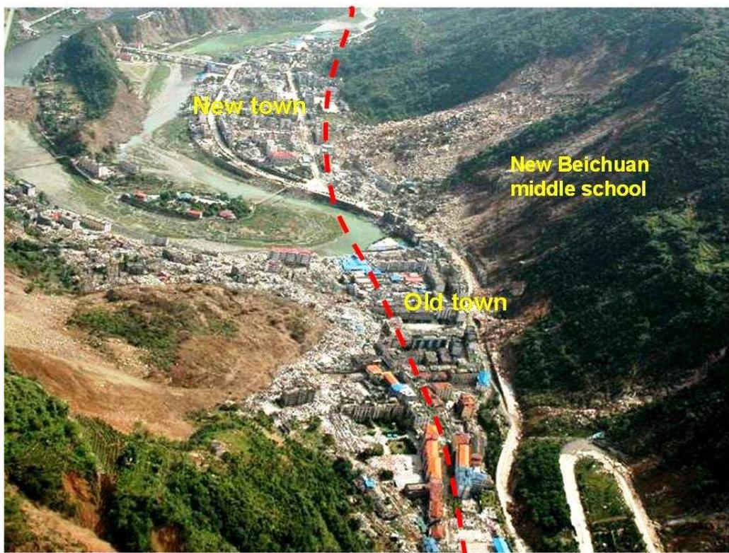
Figure 50 : Ville de Beichuan, avant puis après le séisme. Noter l'important glissement au premier plan et le bourrelet de débris d'habitations et l'éboulement au second plan. Le passage de la faille de Yingsu-Beichuan est indiqué (document communiqué par Huang R. Q.).
