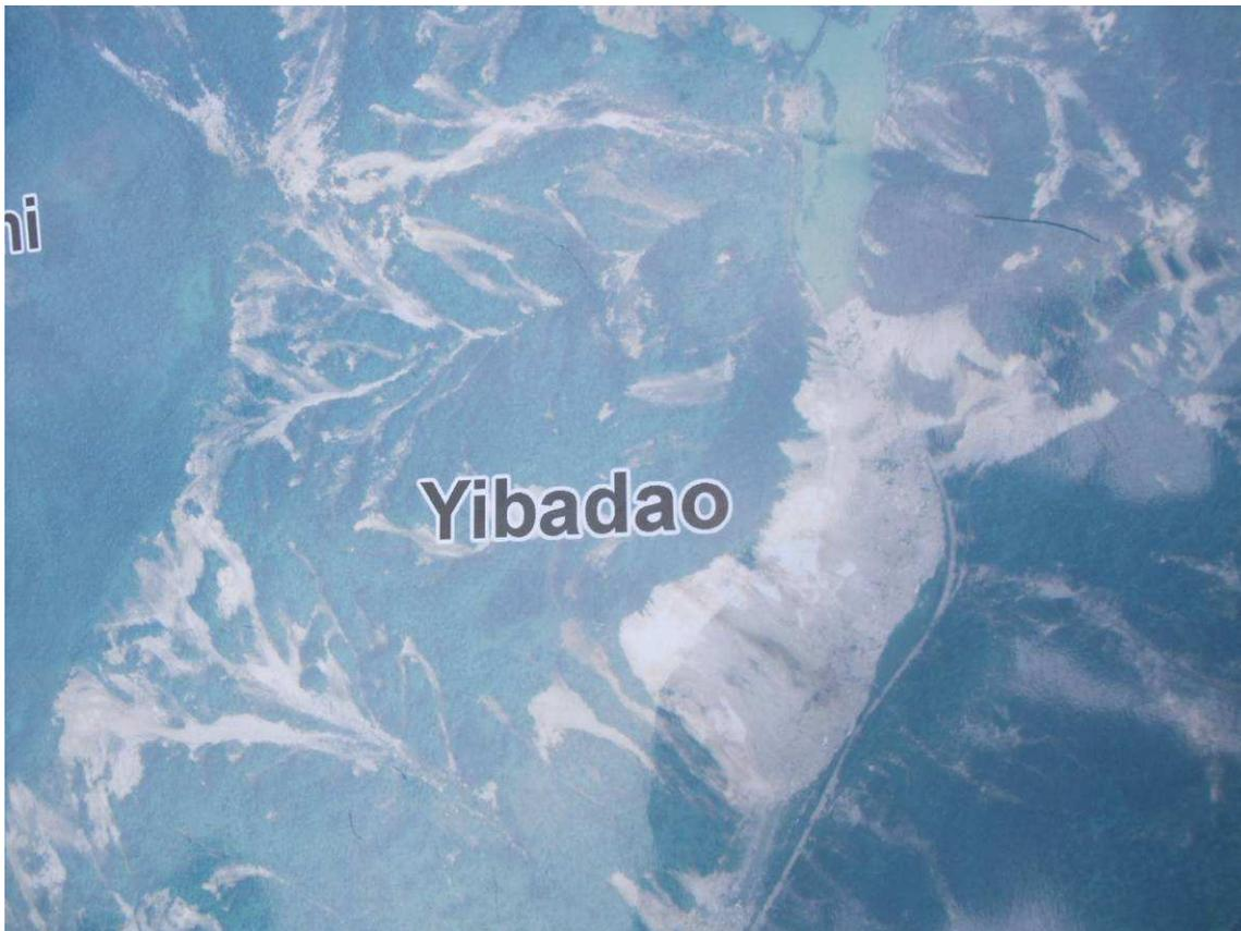
*Figure 69 : Vue aérienne du secteur de Yibadao. On distingue plusieurs zones source de glissements rocheux et éboulements, ainsi que la partie aval du lac de barrage (la rivière s'écoule du haut en bas de la photo)*
