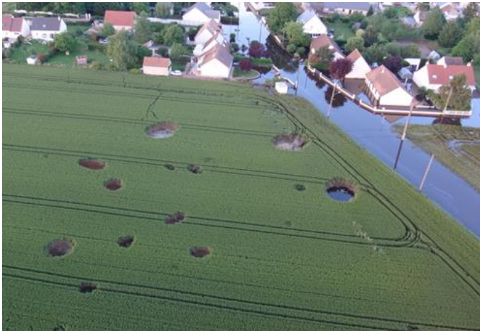
Effondrements au droit d'une ancienne carrière souterraine à Gidy © BRGM 2016
