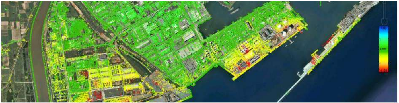
Cartographie par interférométrie radar Le port de Barcelone surveillé par Atlas
